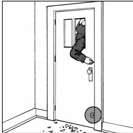
Figure 13 Le voleur ne gagnera pas à briser la vitre si le verrou auxiliaire est hors de portée.
