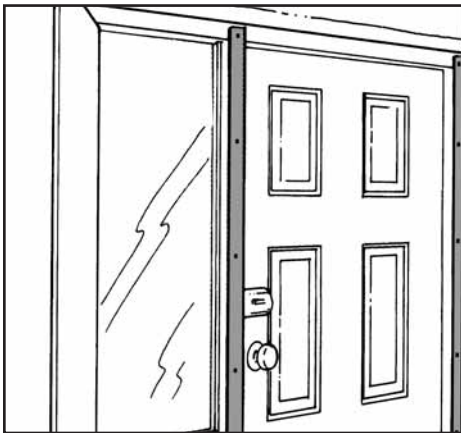
Figure 5 Servez-vous de longues vis pour fixer la bande de métal au bâti d'une porte avec panneaux latéraux vitrés.
