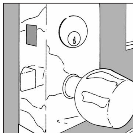
Figure 18 Une plaque métallique aide à renforcer le bois autour de la serrure d'une porte en bois.
